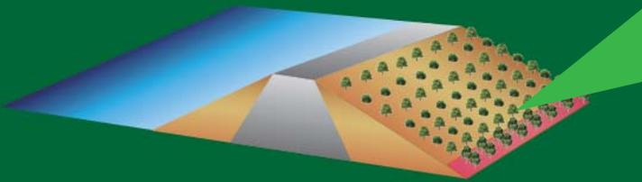
東日本大震災に伴う津波被害では津波対策として施されていた多くの防波堤や海岸林が破壊され機能しませんでした。遠州灘も同じく津波被害が予想され防波堤や海岸林の対策は不可欠といえます。被災地でも生き残ったタブ・シイ・カシ類の広葉樹を主木に植樹し根を深く張らせ相互に絡みあうことにより津波に耐える土壌を形成させる自然の盾が「防潮森」です。
